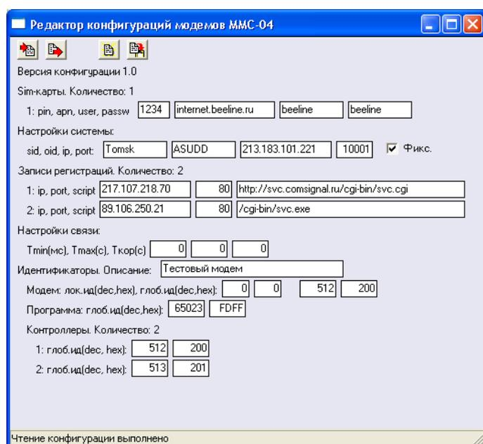
Чаще всего изменению подлежат настройки сотового оператора, а также идентификаторы модема и светофорных объектов. Для удобства идентификаторы выводятся в десятичном и шестнадцатеричном виде. После изменения нужных параметров, конфигурация должна быть загружена в модем и желательно сохранена в файл для последующего использования в будущем.
