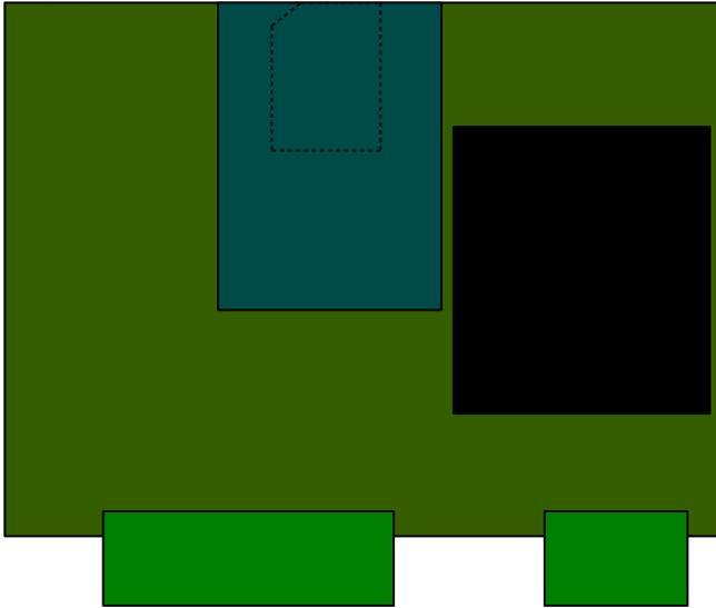
модуле GR64 держатель, в MMC-04 держатель sim-карты расположен под модулем в зазоре между модулем и платой, поэтому установка sim-карты в модем MMC-04 более сложна и требует некоторого навыка.
