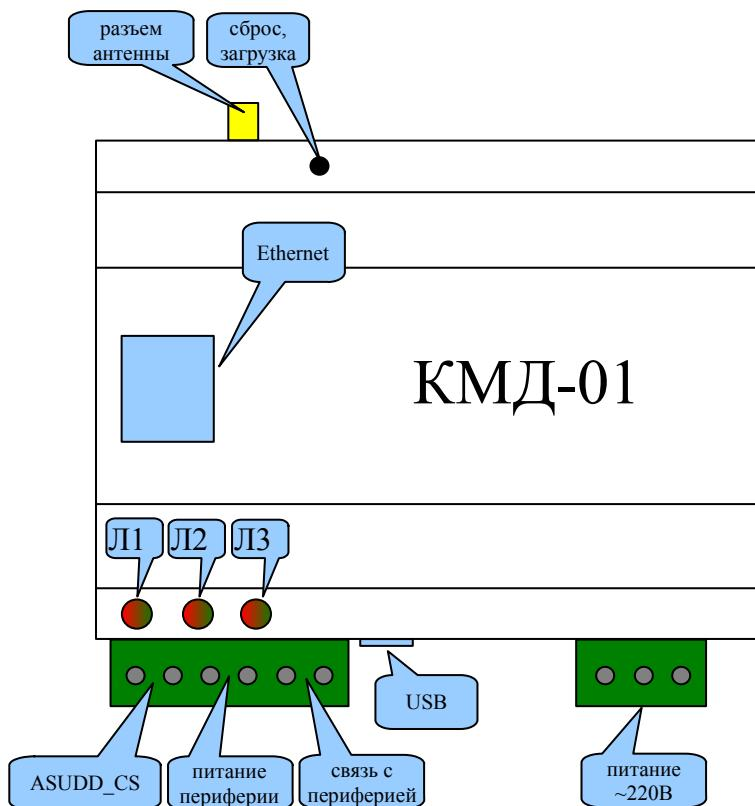
Устройство модема схематично отображено на рисунке. Кнопка «сброс, загрузка» доступна длинным острым предметом через отверстие в корпусе. Служит для перезапуска модема, либо для перехода в загрузочный режим. В загрузочном режиме возможна перепрошивка программы модема, а также изменение конфигураций защищенных программ. Про загрузочный режим будет описано ниже. Индикатор L1 красным цветом подсвечивает загрузочный режим, а зеленым состояние модуля GSM.
