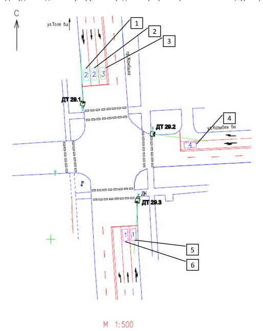
В программе конфигуратора на вкладке адаптивного управления выбирается алгоритм управления. Кнопкой с красным плюсом добавляются фазы движения, указываются их номера. Потом в списке мышкой выделяется фаза и добавляются датчики, работающие на подсчет транспорта во время этой фазы (к слову, их может и не быть, если фаза движения или полоса не настолько важна).
