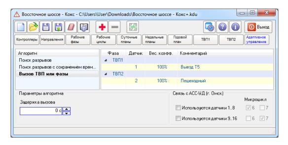
Пример выше составлен для модели КДУ-3.2H версии 2, она позволяет вызвать до 4-х фаз (программ ТВП). Модель КДУ-3H версии 1 с прошивкой kdu3n14c позволяет вызвать только одну фазу.
